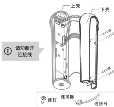
3 拆掉电池3处螺钉后,取出电池。
