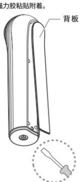
2 拆出下壳4处螺钉,将上壳和下壳分开,并将连接线和连接器拆下。
