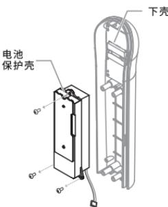
4 用塑料尺等细薄的物体将电池从电池保护壳内取出。
