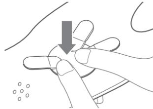
左右取付位置マークを確認し、シリコーンマスク裏の溝にコントローラーを押し込みます。
