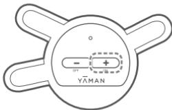
左右のコントローラーの+/-ONボタンを同時に1秒以上押します。
