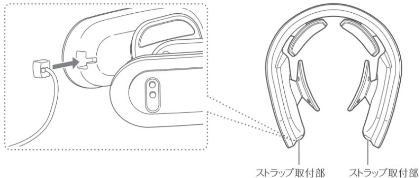
ストラップをストラップ取付部2箇所に角度を合わせて差し込みます。
