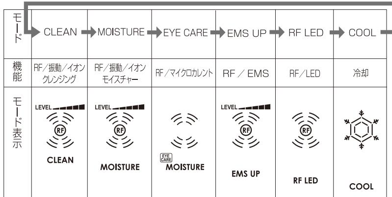
※CLEAN・MOISTURE・EMS UP モードのケア時にモード表示のは表示・非表示を繰り返します。「ピッ」という音がするとRFが動作します(モード表示のが表示)。「ピピッ」という音がするとイオンまたはEMSが動作します(モード表示のは非表示)。
