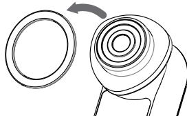
2 電極ヘッド部分にコットンを1枚のせ、コットンストッパーを押し込むように付ける。
