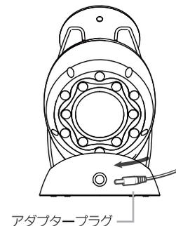
3 充電完了後、ACアダプターをコンセントから抜き、アダプタープラグを充電台から抜く。
