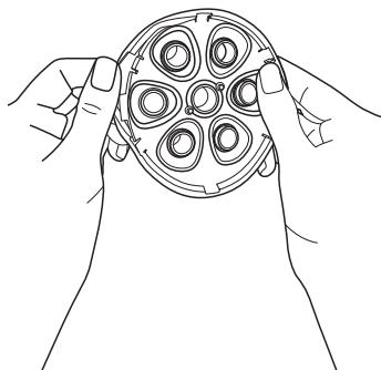
**5** うすめた中性洗剤でアタッチメントと枠についている汚れを落とした後、水で洗い流す。
