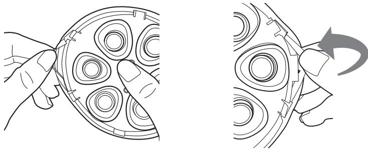
アタッチメントの縁を枠に巻き付けるように取り付ける。
