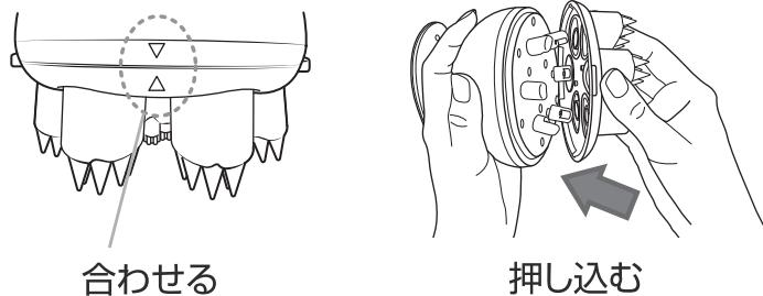
・アタッチメント・枠の表裏上下を確認して取り付けてください。アタッチメントの表側の上部に△マークがあります。
