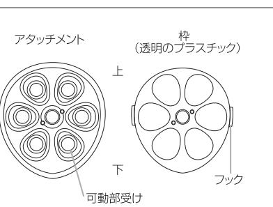
①アタッチメント中央部の突起と穴、左右にあるフックと穴を合わせてください。アタッチメントに枠を乗せ、下図のように穴に凸を合わせ押し出します。
