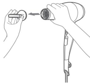
取り外す際は、十分に冷えたことを確認し、ノズルの両端を持って引き抜いてください。
