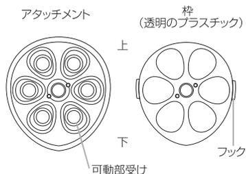
①アタッチメント中央部の突起と穴、左右にあるフックと穴を合わせてください。アタッチメントに枠を乗せ、下図のように穴に凸を合わせ押し出します。
