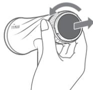
吸込口フィルターを取り外し、吸込口リングを持って反時計回りに回転させながら引き抜きます。
