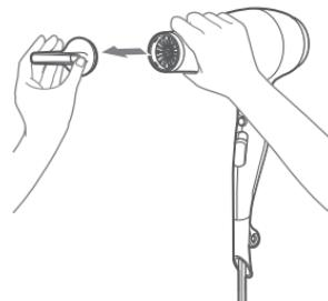
取り外す際は、十分に冷えたことを確認し、ノズルの両端を持って引き抜いてください。
