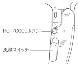
3 使用後はスイッチを「OFF」にし、電源プラグをコンセントから抜く
