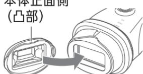
アタッチメントの向きを確認し、本体照射口の上からかぶせるようにして装着します。
