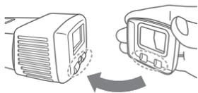
図のようにローラーヘッドの突起部分に合わせて、スポットアタッチメントを装着する。
