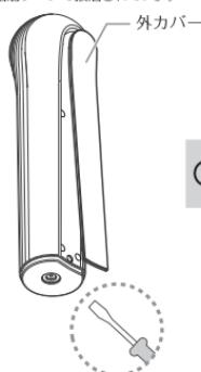
2 下ケースの4ヶ所のネジを外し、上ケースと下ケースに分け、ケーブルとコネクタを外します。
