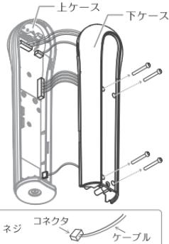
3 下ケースの3ヶ所のネジを外し、電池ケースを取り出します。
