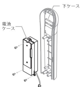
4 プラスチック定規のような薄いもので、電池ケースから電池を取り外します。
