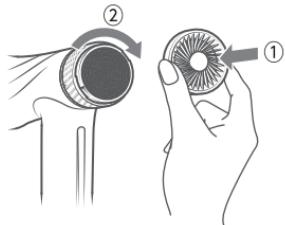
本体と吸入口カバーのツメ2か所が合うように差しこみ、時計回りに「カチッ」と音がするまで回します。
