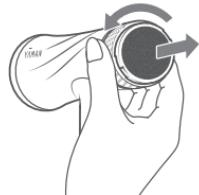
吸入口リングを持って反時計回りに回転させながら引き抜きます。
