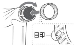
吸入口リングを時計回りに回転させながら、吸入口の奥までしっかりと差し込みます。
