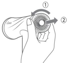
吸入口カバーは、反時計回りに回し、止まった位置から引き抜きます。
